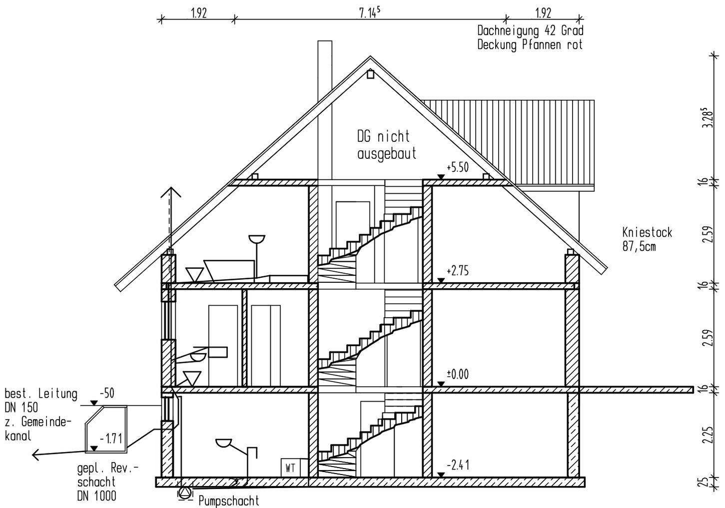
Schnitt A-A mit Entwässerung
